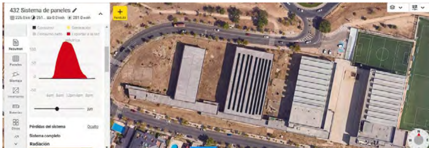
Reproducción del diseño de la instalación y cálculo de producción (utilizando OpenSolar)
