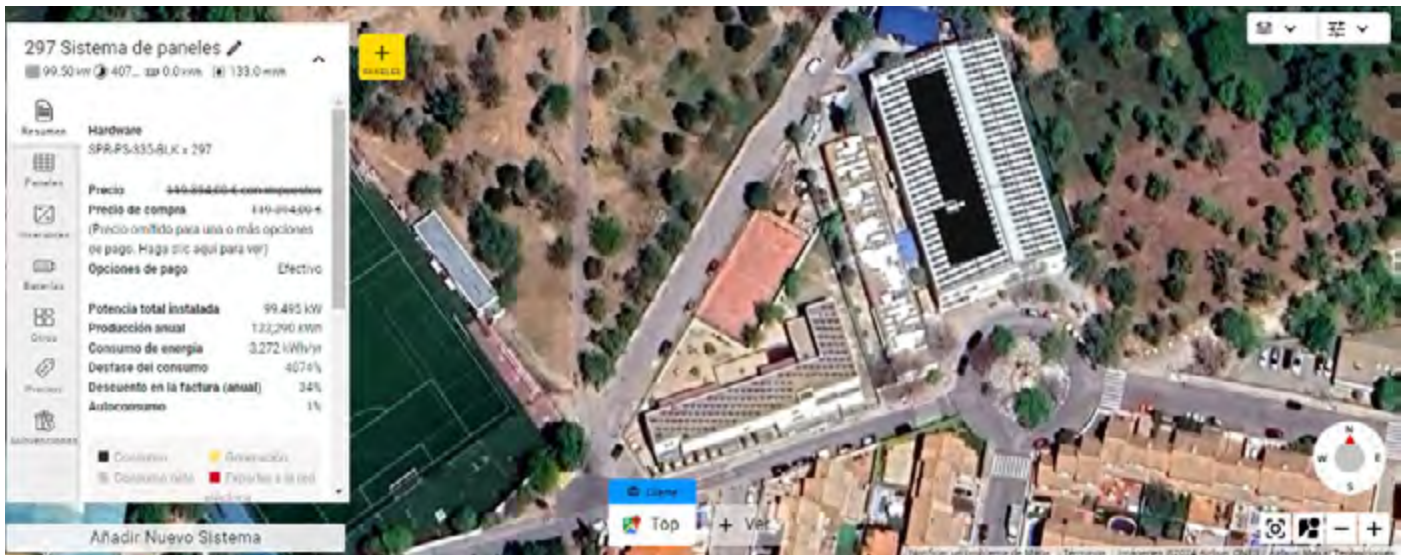
Reproducción del diseño de la instalación y cálculo de producción (utilizando OpenSolar)
