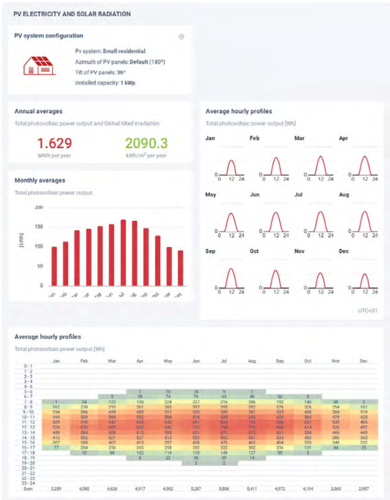
PVOUT_specific Salida de potencia fotovoltaica específica kWh/kWp Valores medios anuales y mensuales de electricidad fotovoltaica (CA) suministrada por un sistema fotovoltaico y normalizados a 1 kWp de capacidad instalada (© 2023 Solargis)
