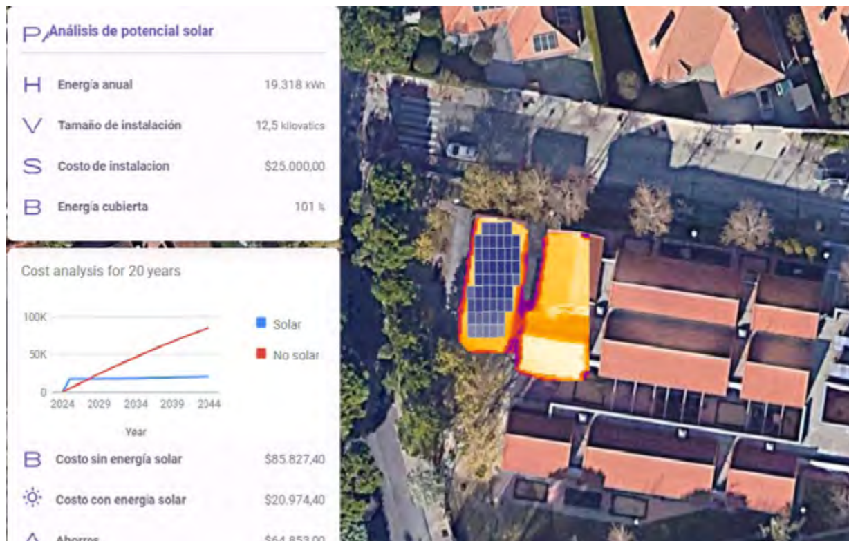
Reproducción del diseño de la instalación y cálculo de producción (utilizando OpenSolar)
