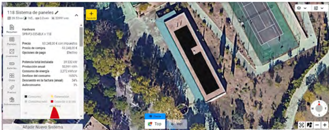
Reproducción del diseño de la instalación y cálculo de producción (utilizando OpenSolar)
