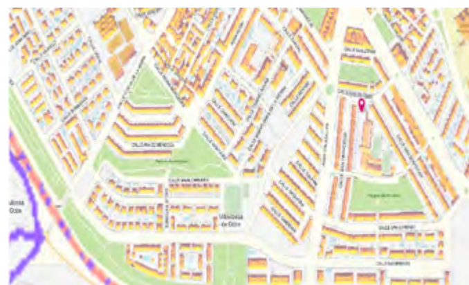
Distribución de la producción de electricidad FV diaria típica en Madrid por cada kW_pico instalado (kWh/m2)/(kW_pico) para cubierta con inclinación y orientación optimas
